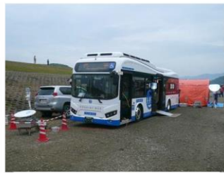
電気バスから非常用電源の取出し
